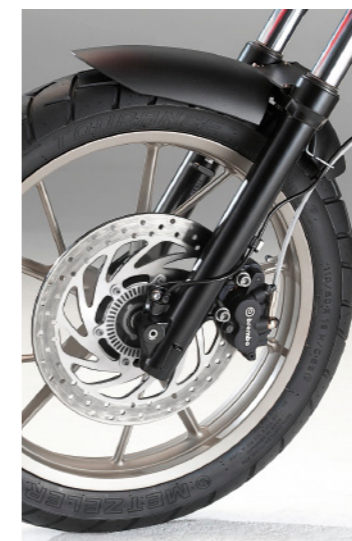
Sparen beim Bremsen: Nur eine Scheibe, deshalb benötigt volle Verzögerung etwas Handkraft. Das ABS ist im günstigsten Preis aber inbegriffen.
